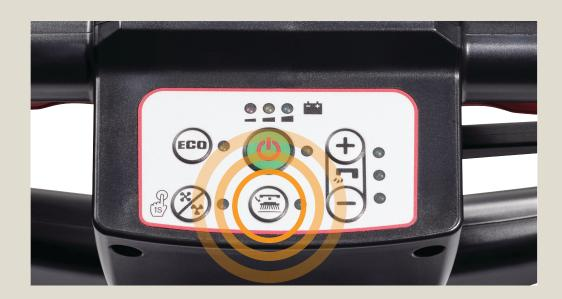
**Ежедневно:** Когда машина включена и поднята дека, нажмите кнопку снятия щетки, чтобы освободить держатель щетку/держатель пэда, затем проведите очистку и осмотр перед следующим использованием.
