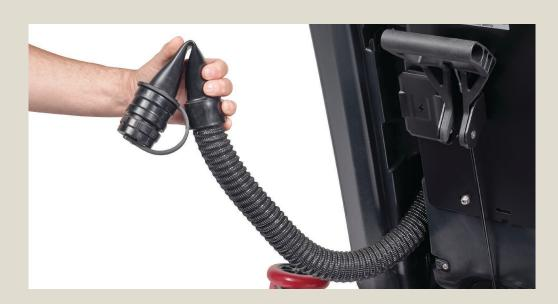
**Ежедневно:** Опорожните бак с грязной водой с помощью сливного шланга. Пережмите шланг, перед тем как снять колпачок, чтобы избежать разлития жидкости.
