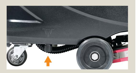
**Ежедневно:** Опорожните бак для чистой воды с помощью пробки для слива бака с раствором под машиной.
