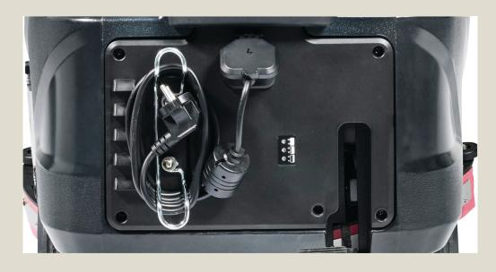
**Ежедневно:** Зарядка аккумулятора: Подключите кабель зарядного устройства к сетевой розетке. Индикатор загорается красным при зарядке и зеленым по окончании зарядки.
