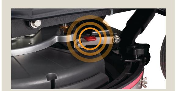
Вручную поднимите скребок до его фиксации в верхнем положении и отключите всасывание для двойной очистки. Для возврата в рабочий режим используйте красный рычаг, чтобы освободить скребок. Затем снова включите всасывание.
