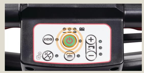
Когда машина включена, нажмите один из предохранительных выключателей, чтобы активировать щетку/ держатель пэда, затем отпустите его. Если необходимо, повторяйте процедуру до тех пор, пока щетка/
